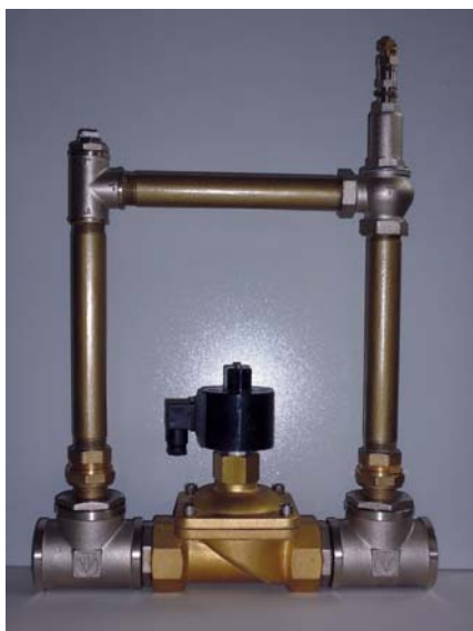
Рис. 1. Импульсный регулятор расхода теплоносителя
